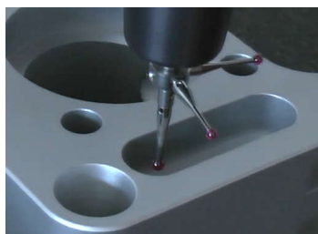
Fig. 42. Posibilitatea de coliziune între elementele de palpate și piesa măsurată
